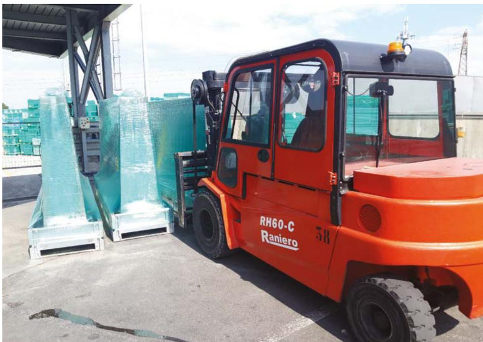
Utilizzare un carrello con portata 60 Q.li e dotato di forche di 2,7 m.
